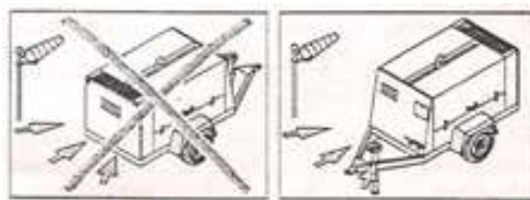
Figura 2: Posição do compressor em relação à direção e sentido do vento.
